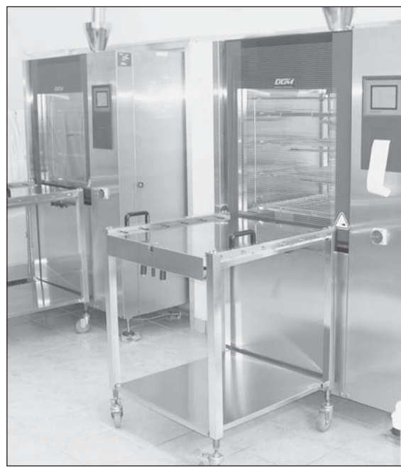
Оборудование для дезинфекции и стерилизации, установленное в ГKB № 52, – паровой стерилизатор, дезинфекционно-мочные машины.
