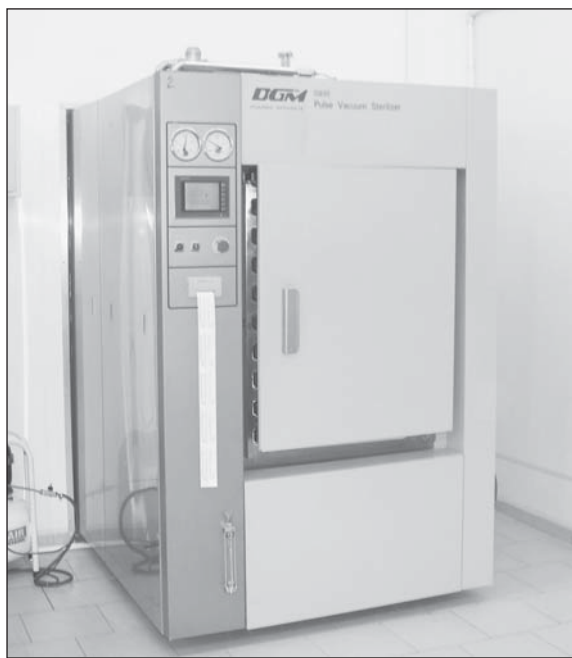
Оборудование для дезинфекции и стерилизации, установленное в ГKB № 52, – паровой стерилизатор, дезинфекционно-мочные машины.
